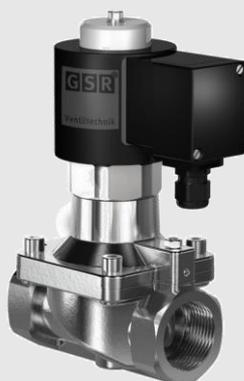
**Electrovanne 2/2 voies****NF - Vanne normalement fermée au repos****NO - Vanne normalement ouverte (option)****Vanne pilotée à membrane attelée.****Fonctionnement sans pression différentielle.****En standard (NF) fermée par la force d'un ressort**
