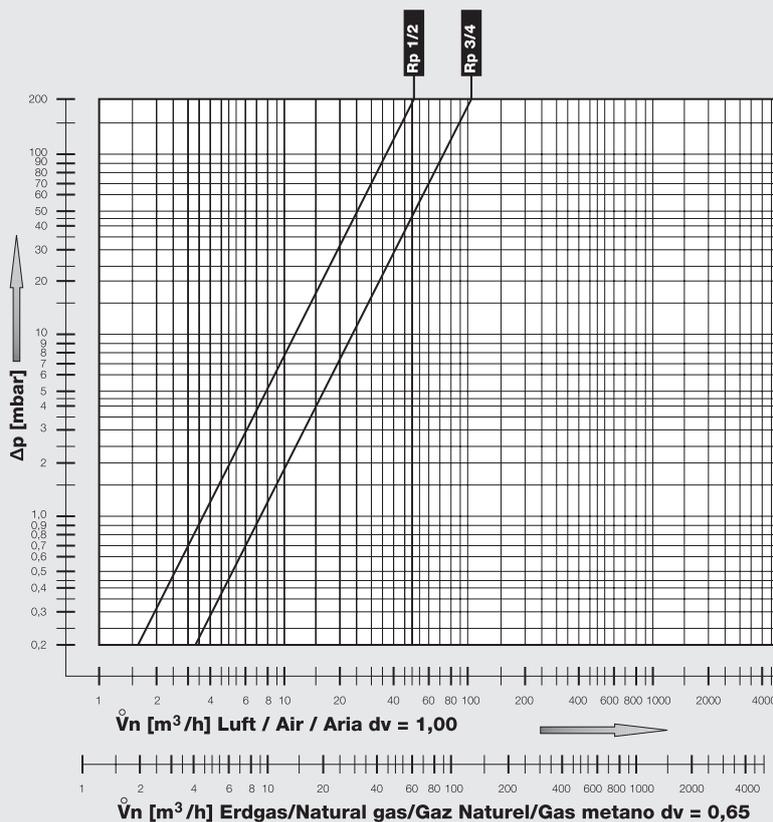
$$\dot{V}_{\text{verwendetes Gas/gas used/ gaz utilisé/gas utilizzato}} = \dot{V}_{\text{Luft/air/aria}} \times f$$
