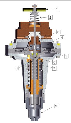
La chambre 4 est reliée à la pression de sortie via une conduite d'impulsion. La pression à contrôler agit sur la membrane de travail 5. La force des ressorts de consigne 7 et 8 sert de contre-force. En cas de déséquilibre des forces (surpression ou dépression), la SAV se déclenche et bloque l'alimentation en gaz.
