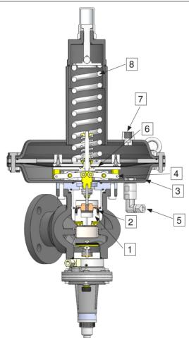
Lorsque la pression de sortie augmente, la force de l'assiette de membrane inférieure 3 sur la membrane de travail 6 augmente.
