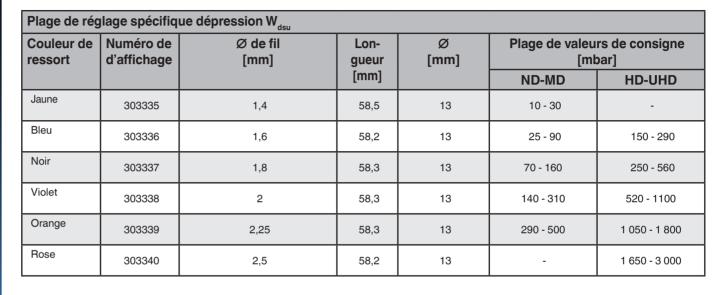
réglage intégré. Le ressort externe 1 du système de mesure permet de régler la pression de fonctionnement supérieure (surpression). Le ressort interne 2 permet de régler la pression de fonctionnement inférieure (dépression). En remplacant les ressorts de consigne, il est possible de régler diverses pressions de fonctionnement. 1 2
