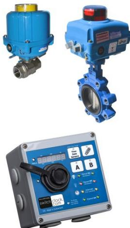
Le signal d'un écoulement non autorisé est analysé par switchclock (appareil de commande). La vanne motorisée ferme la conduite d'alimentation et reste en position verrouillée jusqu'à l'élimination de la cause du dérangement.
