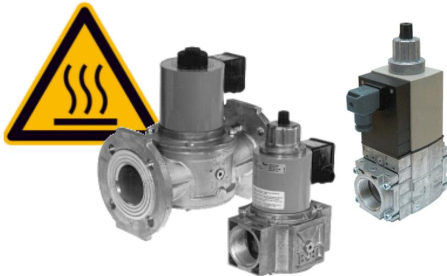
Sicherheits-Magnetventile für Gase der Gasfamilie 1, 2,3 (Erdgas, Propan und Butan) sind aus Gründen der Funktionssicherheit ausschliesslich direkt gesteuerte Ventile. Direktgesteuerte Ventile schalten das Schliesssystem (Dichtelement) direkt über das Magnetsystem.
