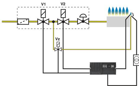
Atmosphärischer Brenner mit Zündgasausgang. Nach der Wärmeforderung wird nach einer einstellbaren Wartezeit die Zündung eingeschaltet und V1 und Vz geöffnet. Nach dem Erkennen der Flamme wird der Hauptgasweg V2 freigegeben.
