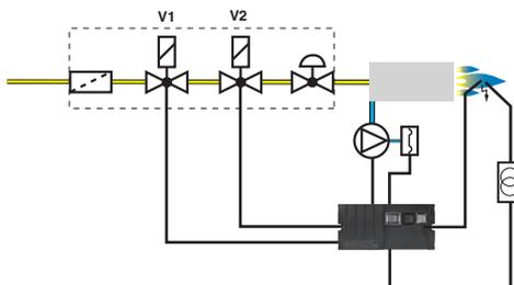
Gebläsebrenner, direkte Zündung der Hauptgasflamme. Nach der Wärmeforderung wird das Gebläse eingeschaltet und durch den Luftdruckwächter der Luftdruck geprüft. Nach Ablauf der Vorbelüftungszeit wird die Zündung eingeschaltet und beide Ventile V1 und V2 gemeinsam geöffnet.
