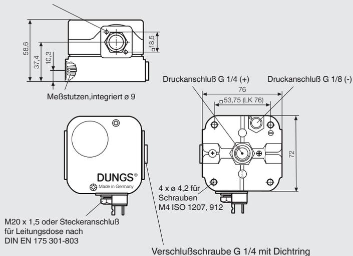
M20 x 1,5 oder Steckeranschluß für Leitungsdose nach DIN EN 175 301-803
